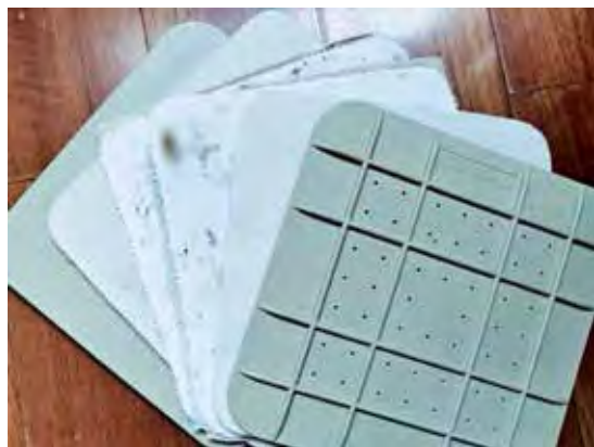
图2-4 微波压花干燥器底板叠放层次
